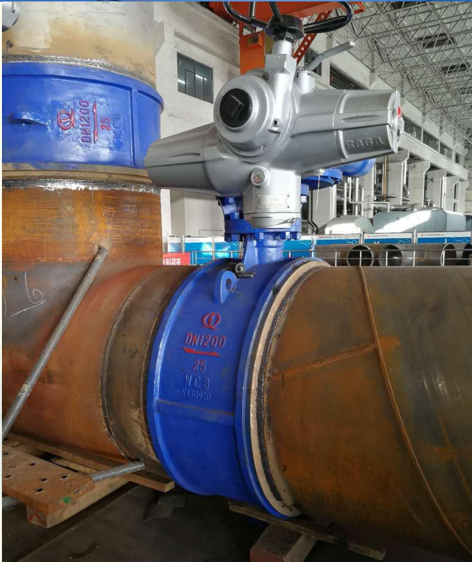
大唐盘山电厂蒸汽管网 1200DQ962H-25
