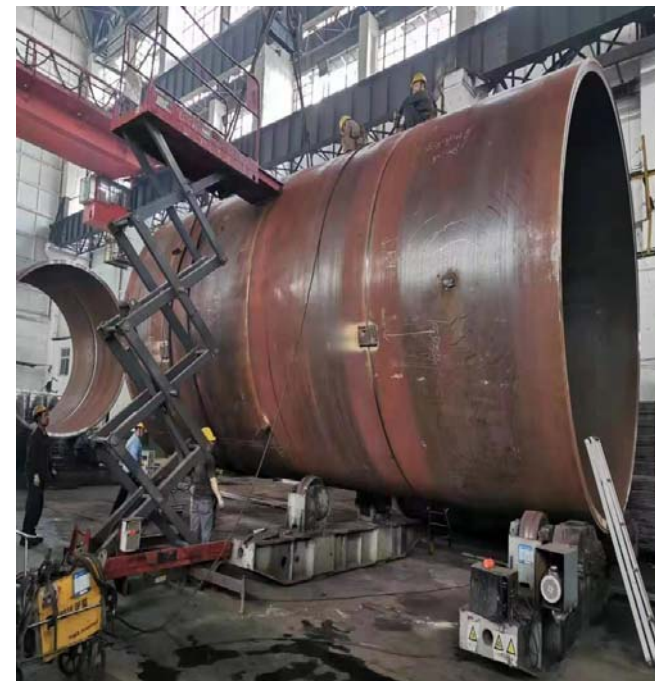
气化炉壳体制作中
