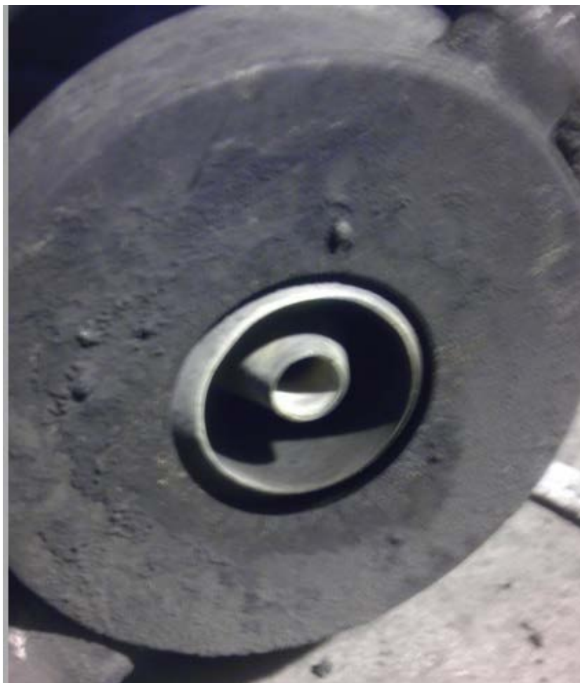
使用 6 个月后工艺烧嘴图片
