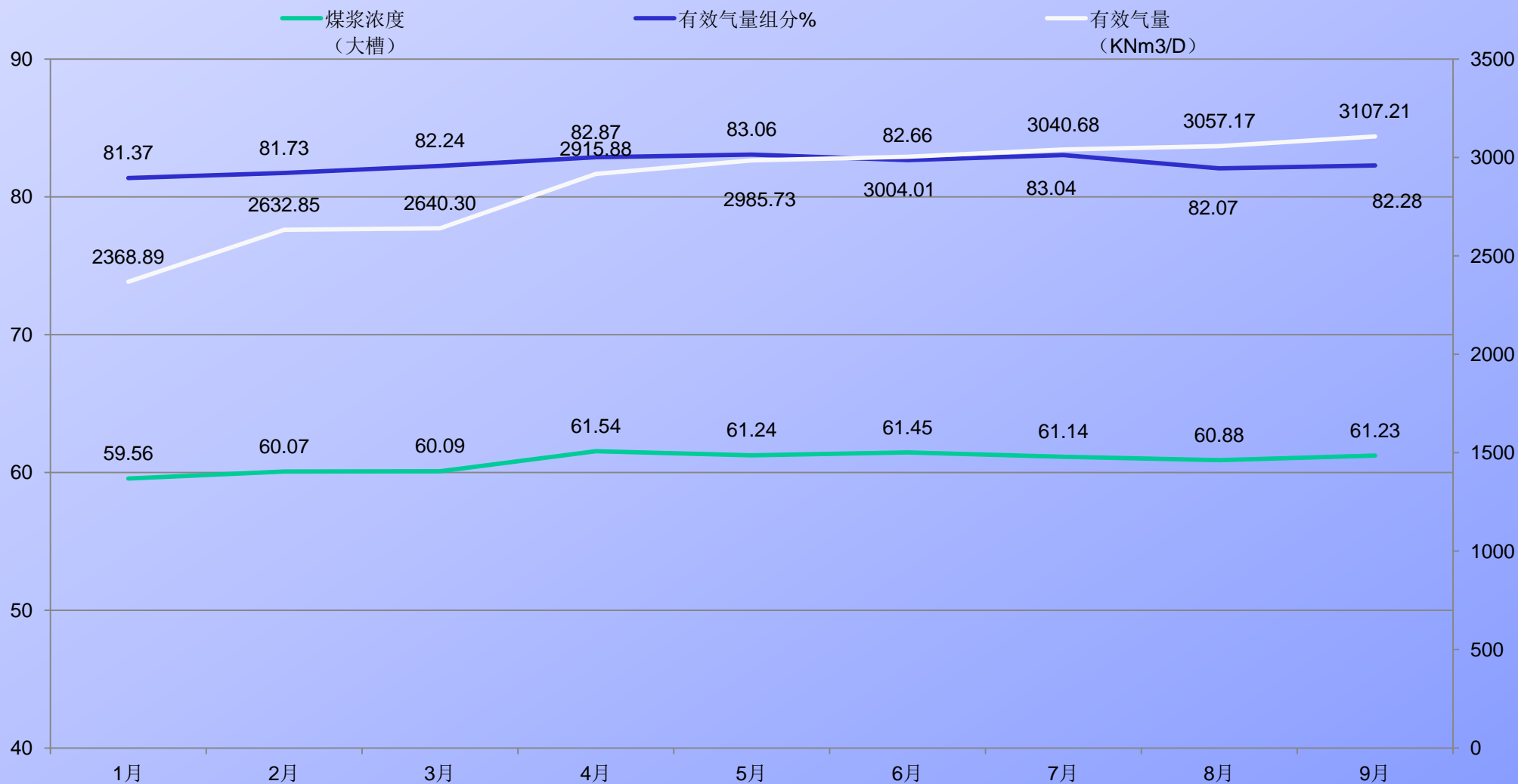
图表3: 4月份实施双磨运行提浓后, 煤浆浓度呈上升趋势各月平均61.2%, 较以前上升1.2个百分点, 有效气组分及有效气量明显上升
