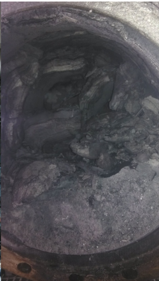
高温热水泵进口管及垢样
