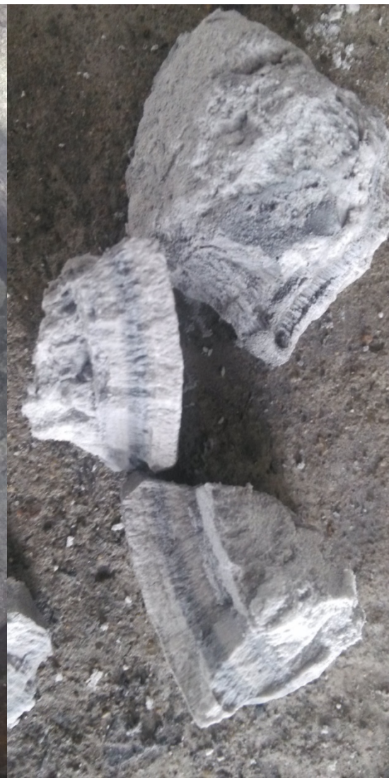
高温热水泵进口管及垢样
