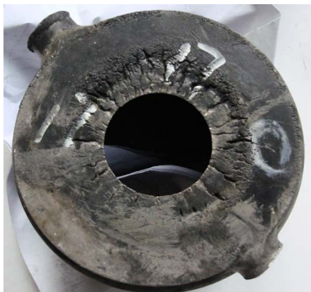
图1 短期损坏烧嘴的宏观分析
