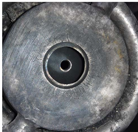
图2 正常退出烧嘴的宏观分析
