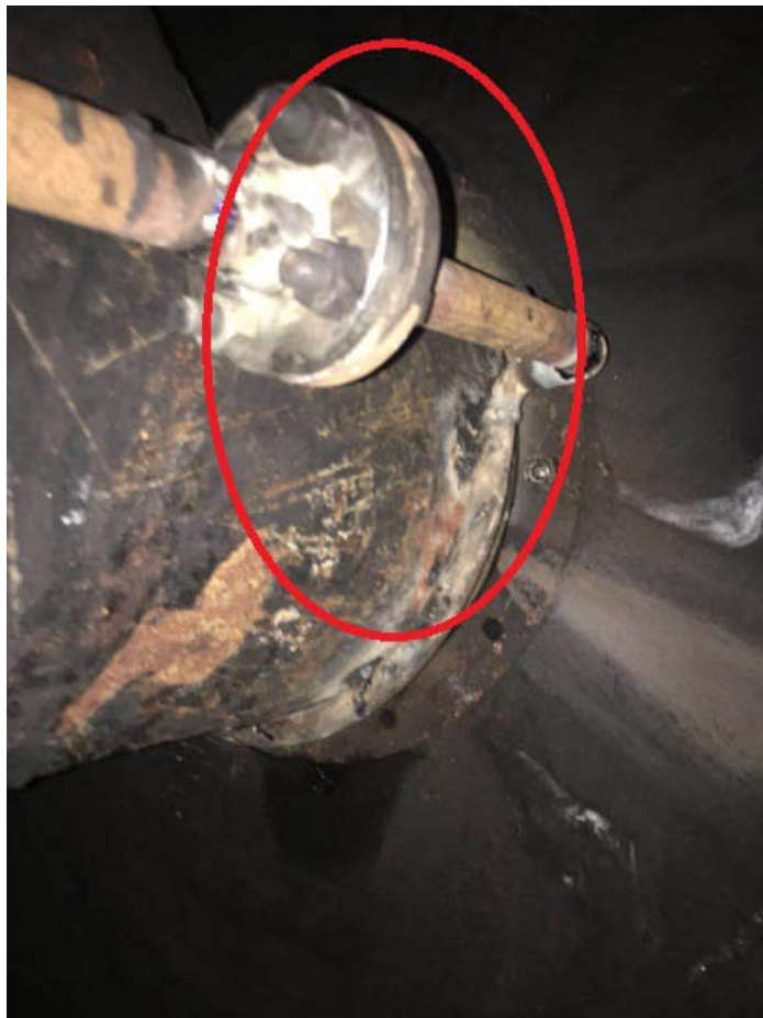
磨机进料端增加吹气管
