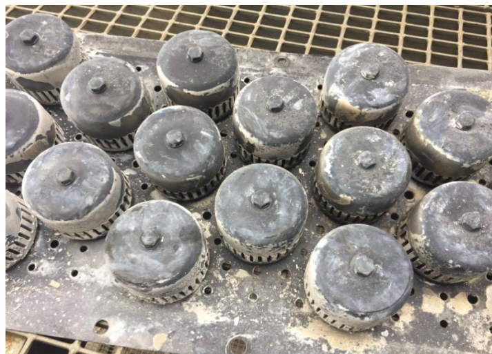
现在水洗塔塔盘情况（90天）
