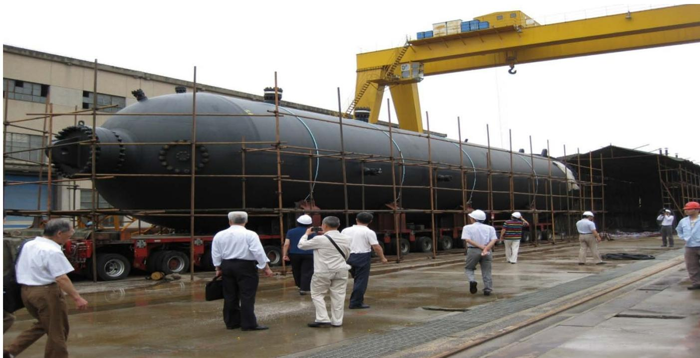
**锻轧钢板应用:**2015年, 中国第一重型机械集团大连加氢反应器制造有限公司在我公司订12Cr2Mo1R钢板606吨, 用于镇海炼化300万吨/年柴油加氢装置加氢精制反应器, 最大单重达到49吨, 最大厚度174mm, 在生产时采用78T正十六棱巨型圆钢锭锻造开坯再进行轧制的生产工艺。
