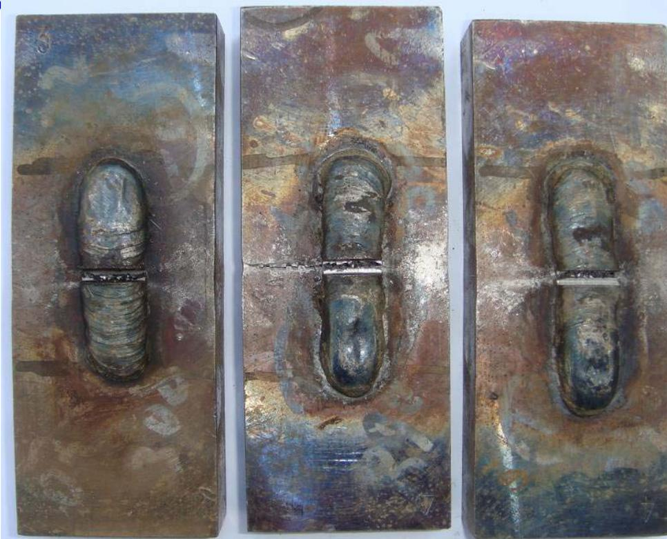
试验按照GB6803进行，在 $-100^{\circ}\text{C}$ 进行试验，试样均未断裂，说明钢板的韧脆转变温度 $\leq -105^{\circ}\text{C}$ ，钢板具有良好的无塑性转变温度。
