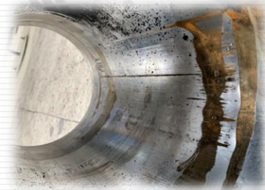
活塞夹紧螺栓断拉缸， 改为一体式
