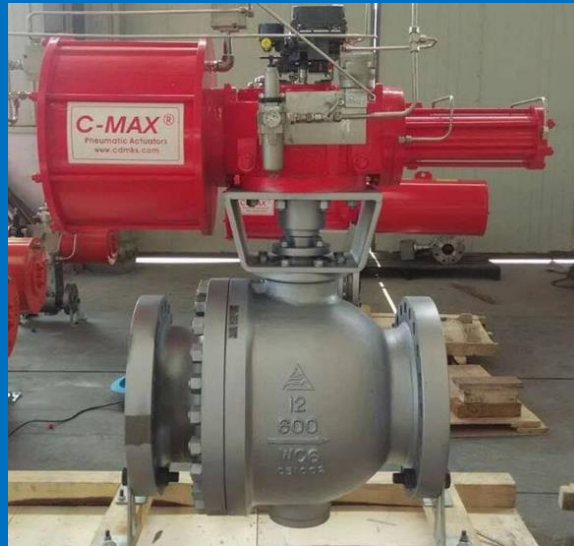
万华（宁波）有限公司 C+V合成气调节阀 代替梅索尼兰套筒阀 2014.8
