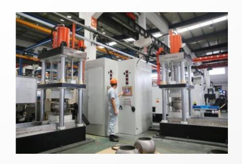
工人扫码后,智能装试一体机即可自动读取系统中的 装配视频和试压参数。启动后,全自动完成阀门的动作试验、密封试验、强度试验等各标准要求的试验内 容;同时,完成试验数据的自动采集和写入,同步完成自动判断,并返写回系统自动生成压力试验报告。
