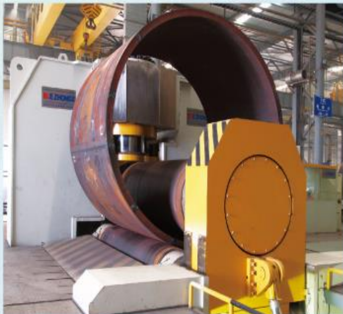
水平式三辊卷板机 冷卷最大270mm,热卷最大360mm
