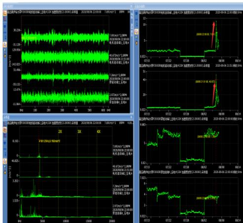
一、结论：电机两端轴承外圈及保持架早期磨损，近期润滑稍差导致振动上升。
