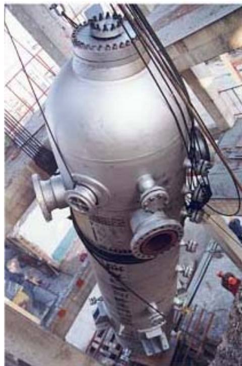
气流床气化炉
