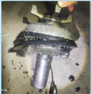
损坏煤浆给料泵阀锥
