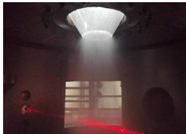
开工喷嘴有机废液雾化实验
