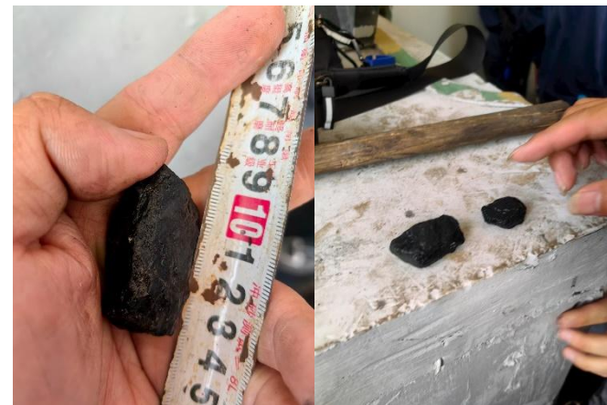
7月16日，煤浆泵2#缸入口单向阀有大块煤
