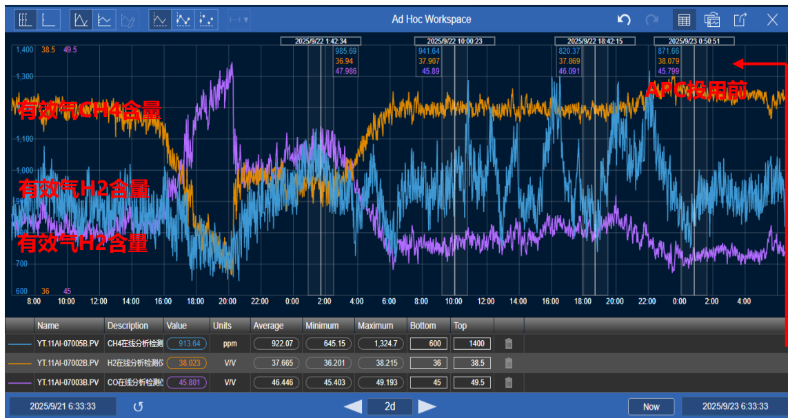
9月23日气化炉B开车前APC未投用情况
