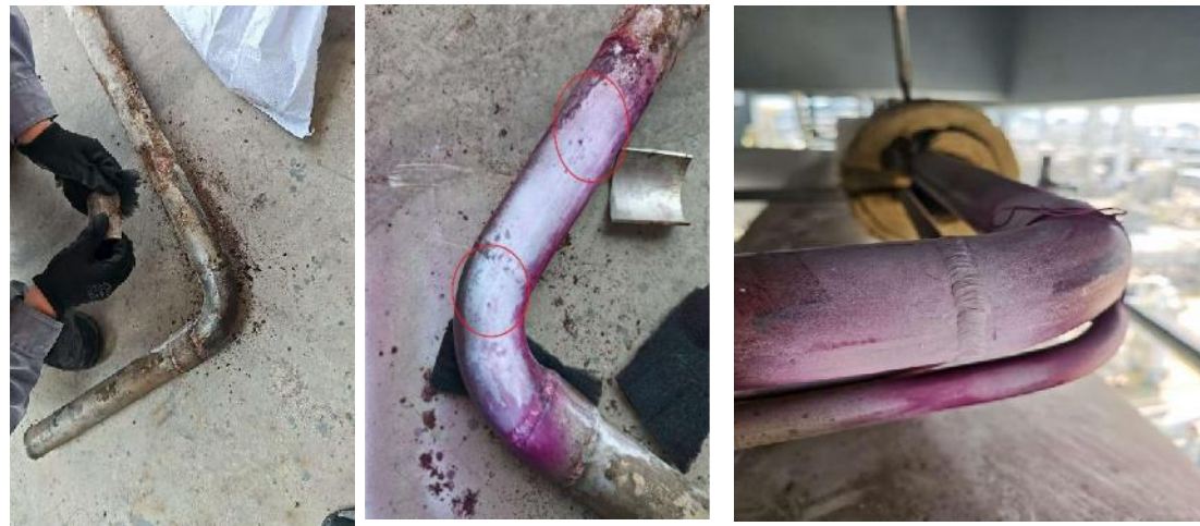
类比排查F系统同位置无腐蚀问题
