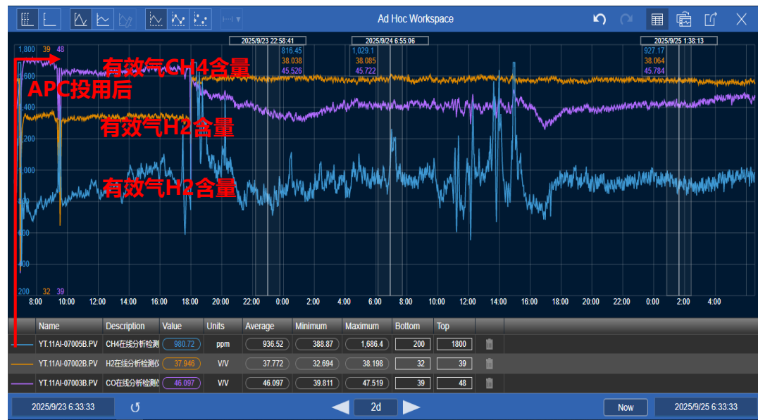
9月24日气化炉B开车后APC投用情况
