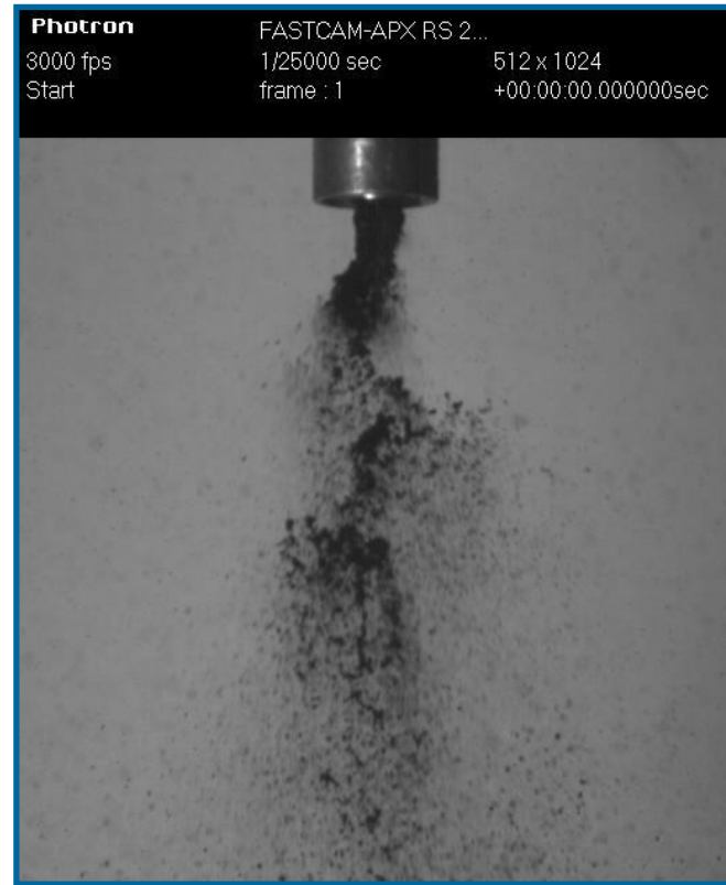
水煤浆雾化过程
