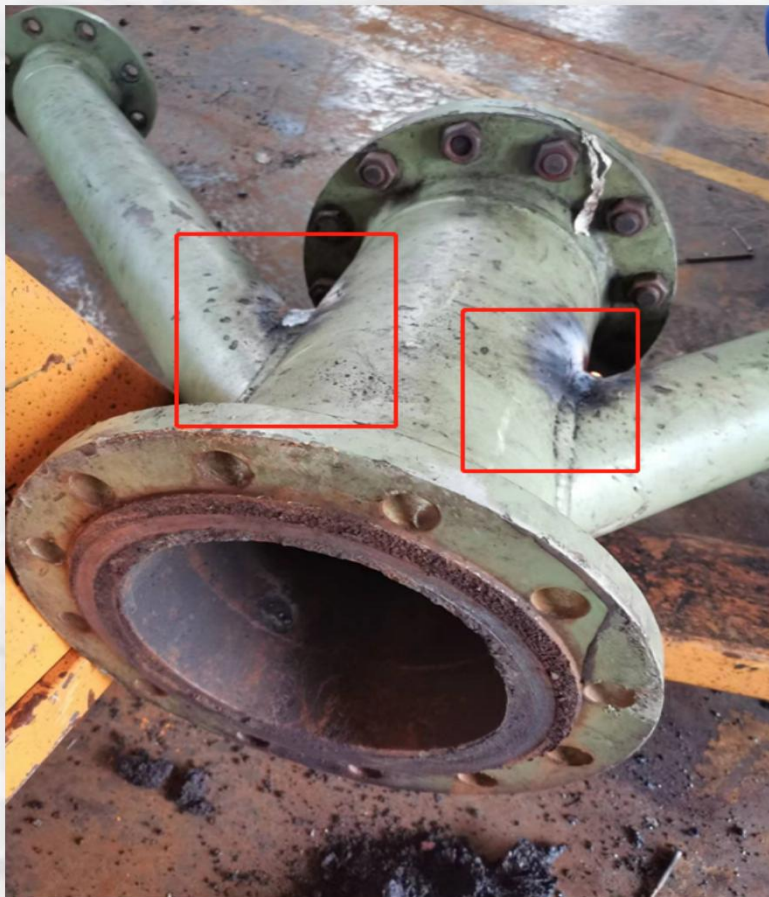
高压煤浆泵入口管分叉口，该部位容易忽略，测厚难度大，需拆检检查
