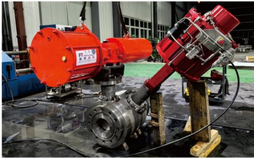
奥科供晋巨合成甲醇洗-分子筛工况 高低温交替耐磨双阻断阀-试验-发货
