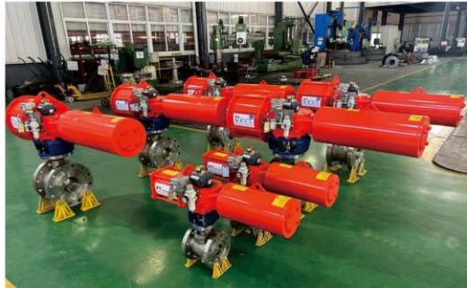
奥科供晋巨合成甲醇洗-分子筛液氮洗工况 高温耐磨半球切断阀-发货前照片
