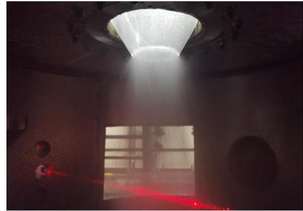
开工喷嘴有机废液雾化实验
